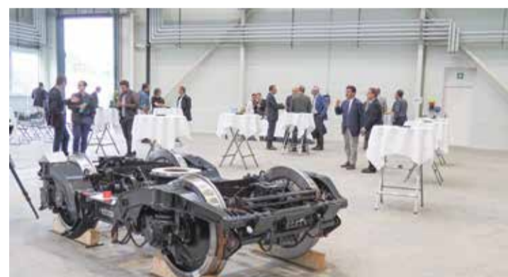
Sorte de petits chariots sur lesquels reposent les wagons, les bogies permettent notamment de négocier les courbes. | DR
