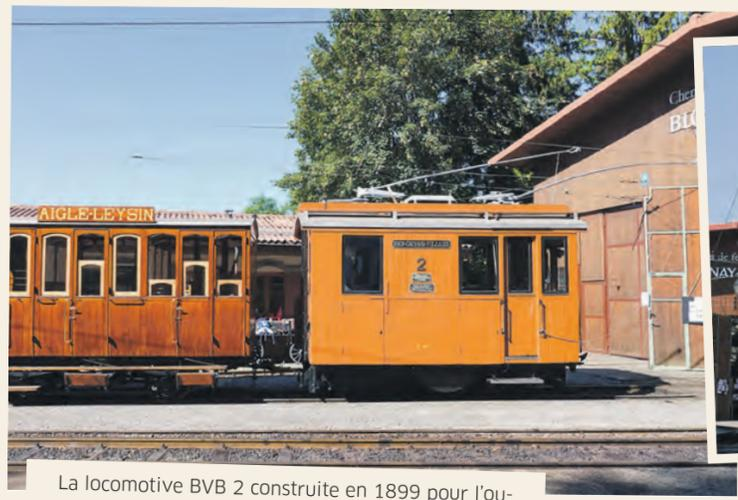
La locomotive BVB 2 construite en 1899 pour l'ouverture de la ligne Bex-Villars et la voiture AL 21 construite en 1900 pour l'ouverture de l'Aigle-Leysin.
